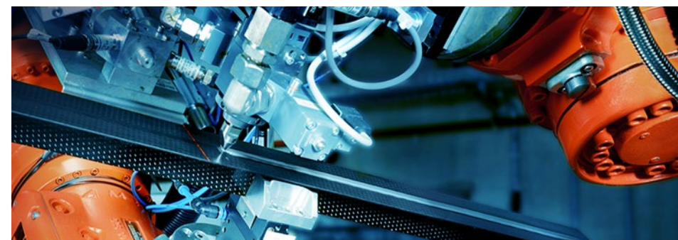
Digitalisierte und automatisierte Klebstoffapplikation
